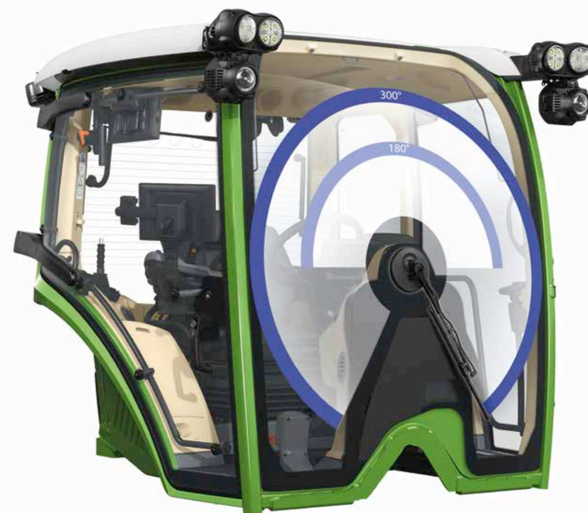
Geriausiam matomumui – 300° priekinis stiklo valytuvas ir 97° šoninis stiklo valytuvas; šildomas laminuoto apsauginio stiklo priekinis langas
