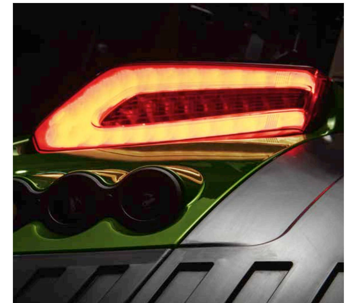
Šviesos diodų galiniai žibintai (palaikantys CAN ryšį) su dinaminėmis mirksinčios šviesos posūkio rodyklėmis
