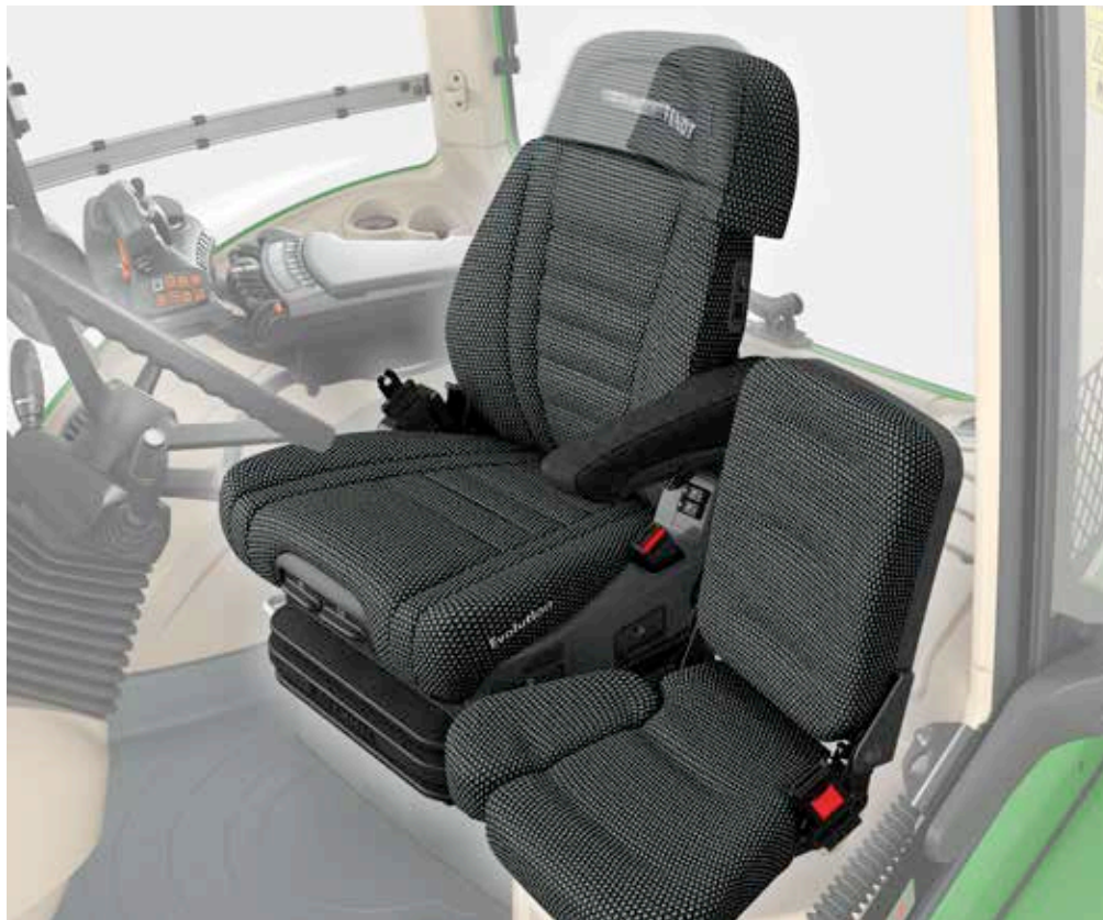
Patogi sėdynė su pneumatine spyruokline pakaba
