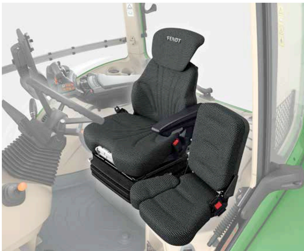
Ypatingai komfortiška sėdynė su pneumatine spyruokline pakaba
