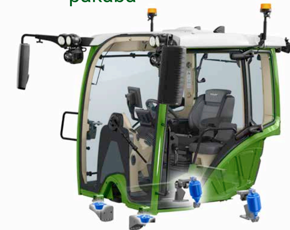
Pneumatinė kabinos amortizacija
