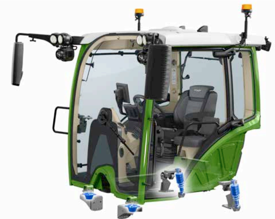
Mechaninė kabinos spyruoklinė pakaba
