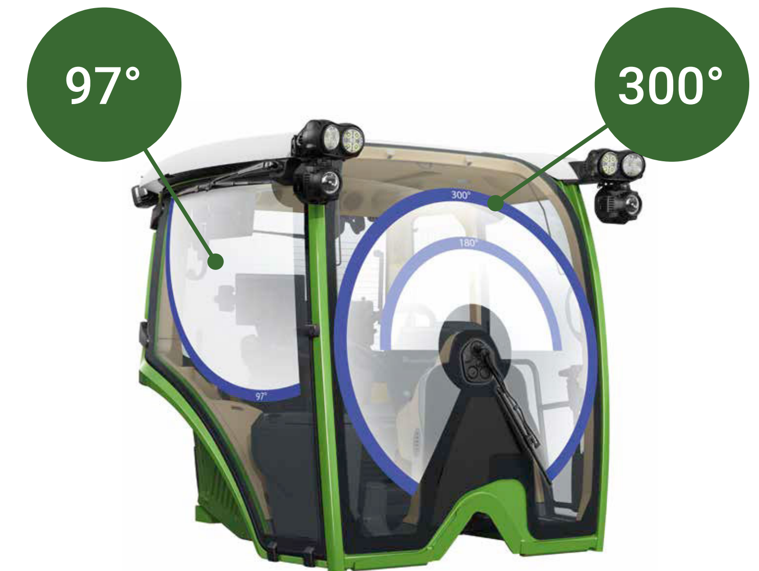
Geriausiam matomumui – 300° priekinio lango valytuvas ir 97° šoninio lango valytuvas; šildomas laminuoto apsauginio stiklo priekinis langas
