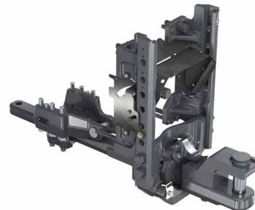
Ištraukiama standžioji vilktis, 4 kat., 50 mm kaiščiai
