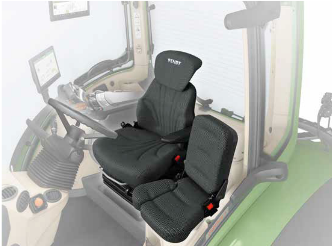
Patogi sėdynė su pneumatine pakaba
