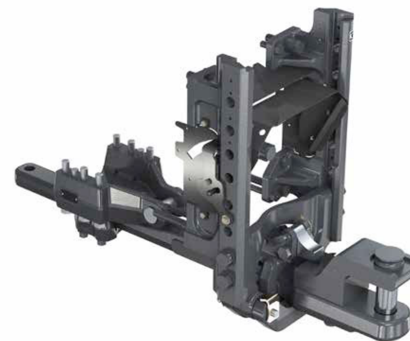
Ištraukiama standžioji vilktis, 4 kat., 38 mm kaiščiai
