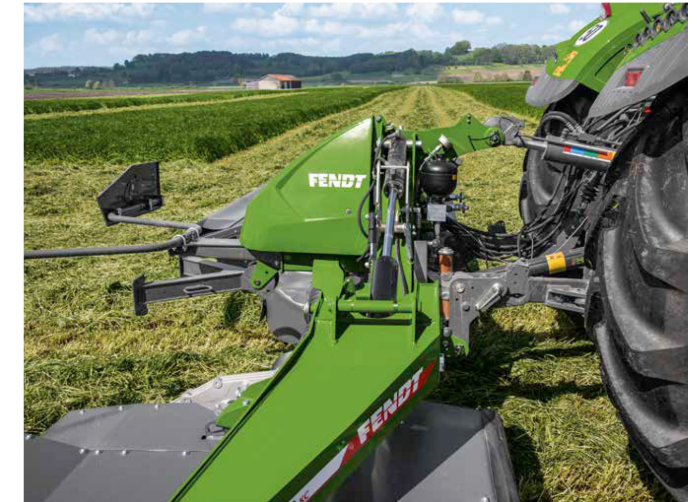
Dėl specialios formos atraminių svirčių įmanomas artimas montavimas
