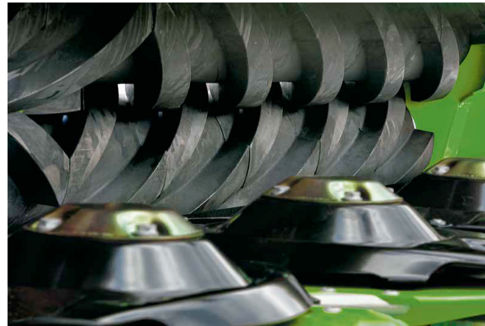
Ritininis plaušintuvas: ankštiniam, tokiems kaip liucerna ir dobilai. Dirba labiau tausojančiai, nei virbinis plaušintuvas.
