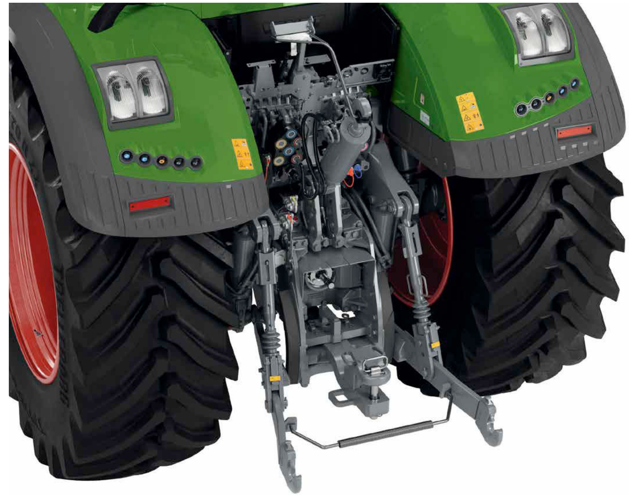
Galinis keltuvas su greito užkabinimo kabliu ir trinties bloku (AU)
