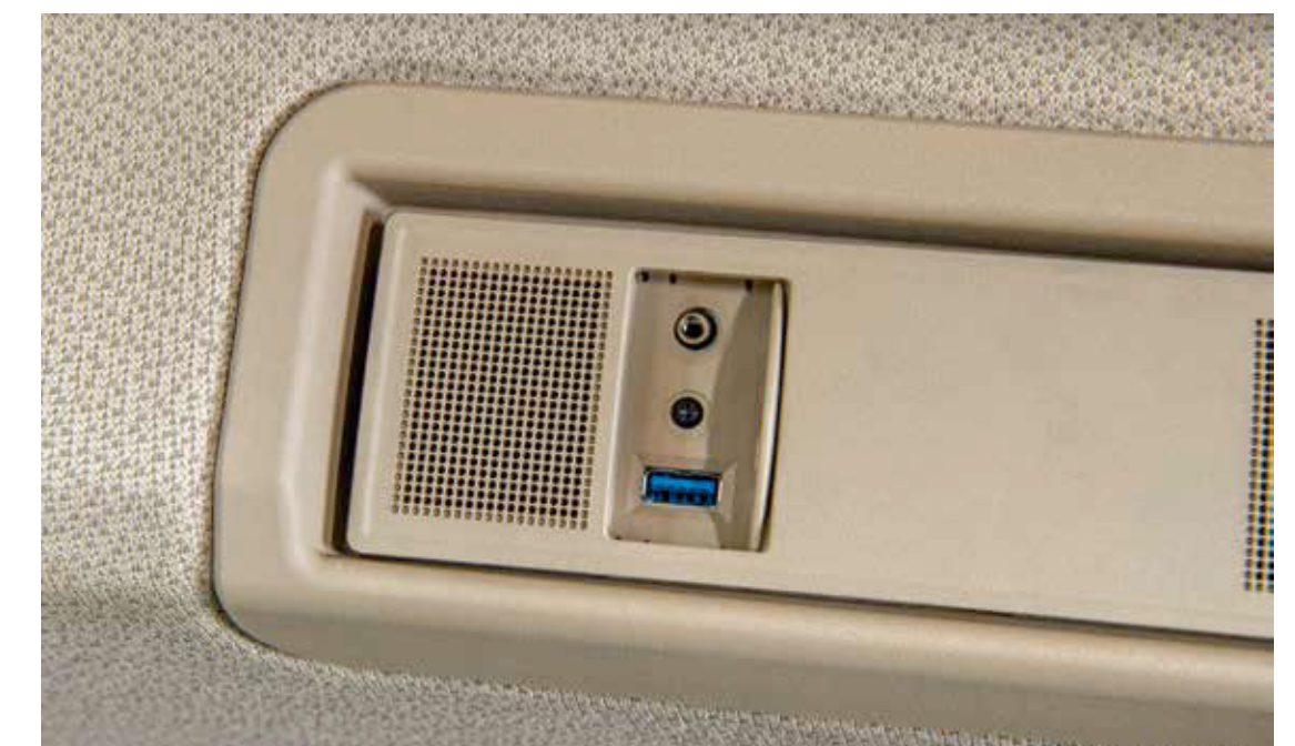
Išorinių garso šaltinių prijungimas per „Bluetooth“ arba kabeliu per USB arba AUX-IN jungtį
