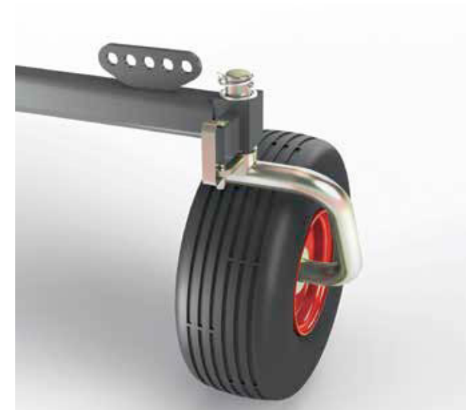
Blokuotas savireguliuojantis ratas
