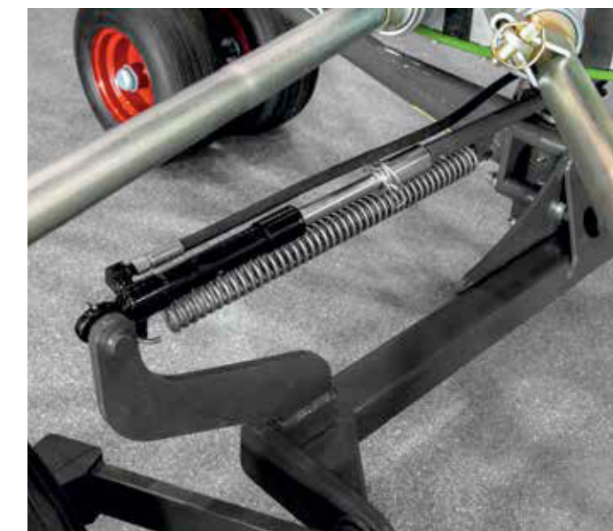
Vienpusio veikimo hidraulinis cilindras su nuleidimu membraniniu akumuliatoriumi (galinis rotorius) arba tempimo spyruokle (priekinis rotorius).
