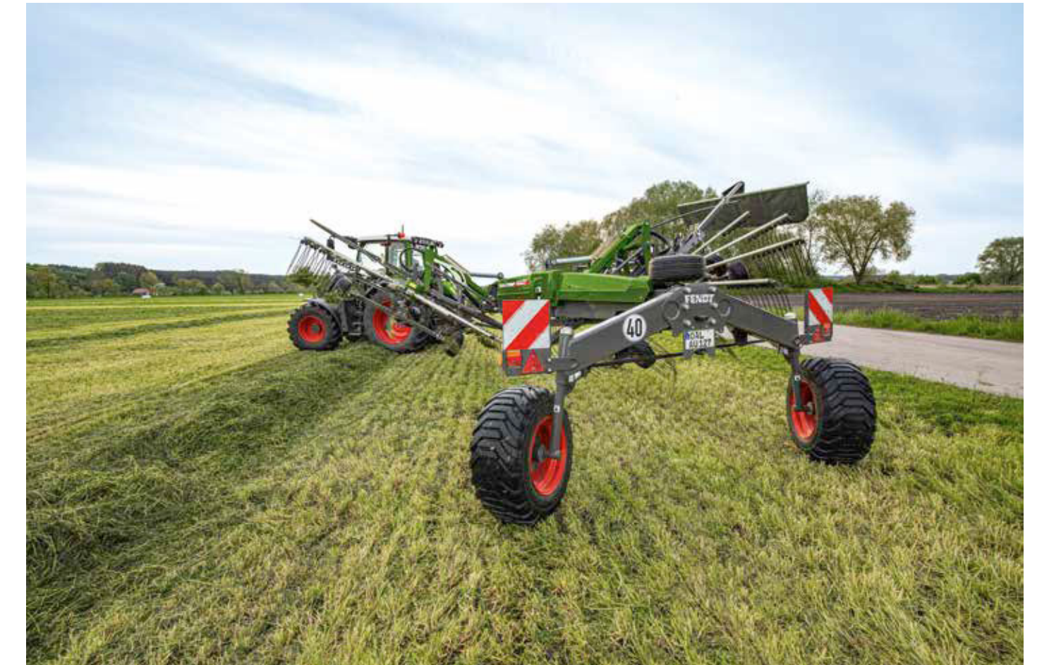
„Former 1603“ ir „Former 7850“ arba „Former PRO“ 2,54 m važiuoklės platiu tarpuvėžiu užtikrina didelį stabilumą važiuojant visose padėtyse.
