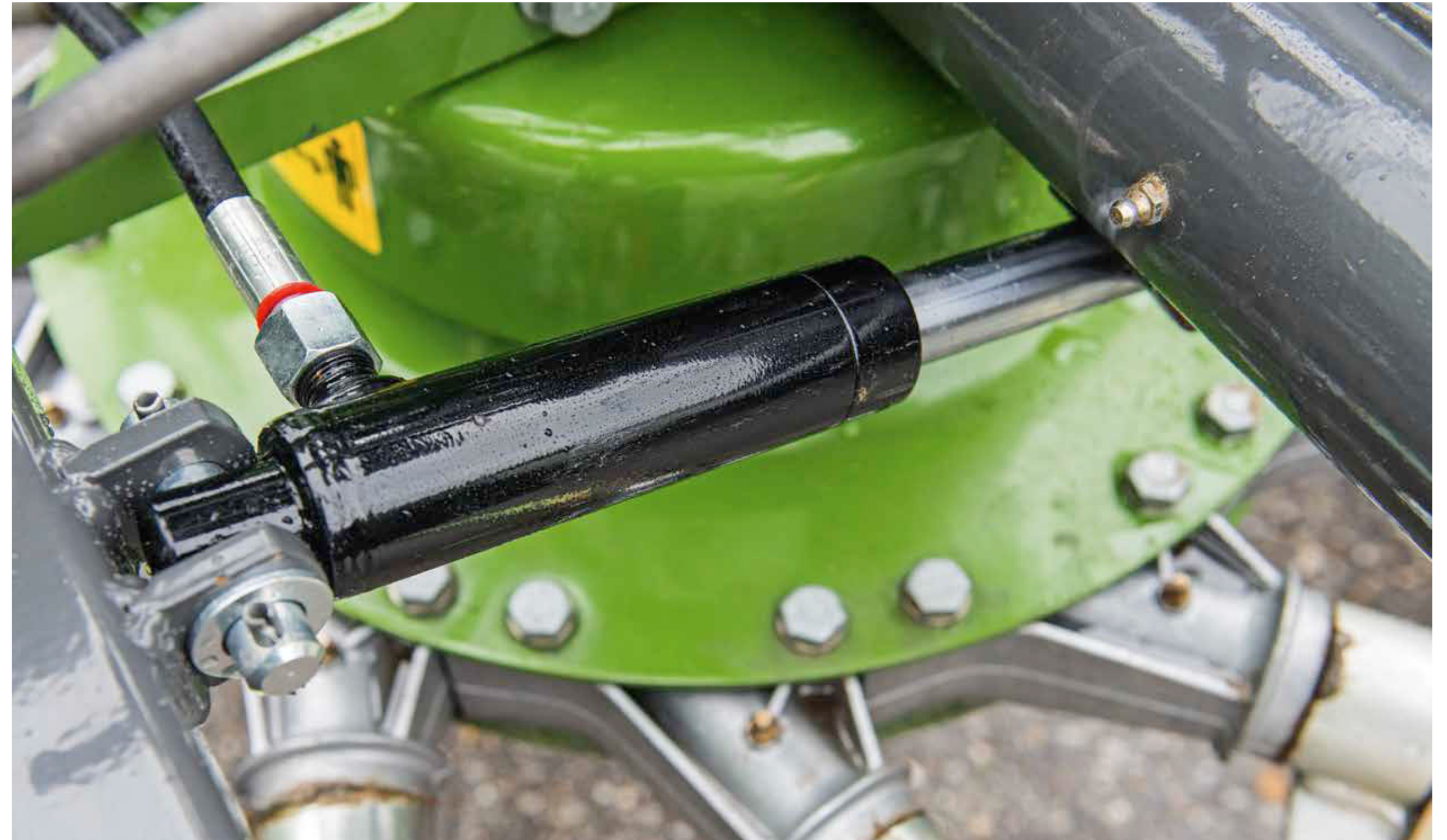
Hidraulinis sąvalkos formavimo įtaiso įjungimas
