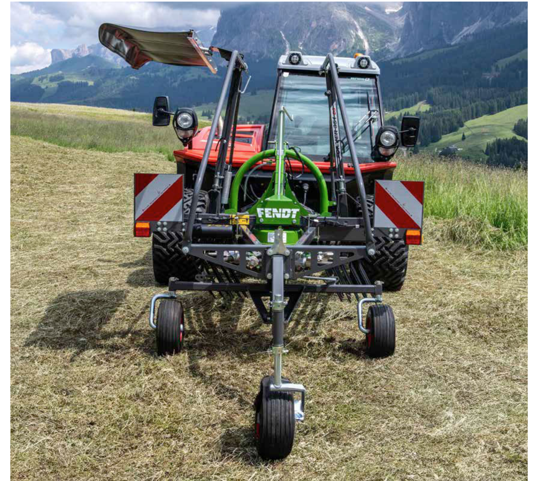
Važiuklė plačiu tarpuvėžiu, suteikiančiu stabilumo važiuojant šlaituose
