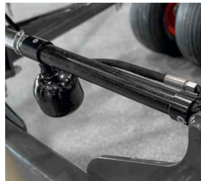
Vienpusio veikimo hidraulinis cilindras su nuleidimu membraniniu akumuliatoriumi (galinis rotorius) arba tempimo spyruokle (priekinis rotorius).
